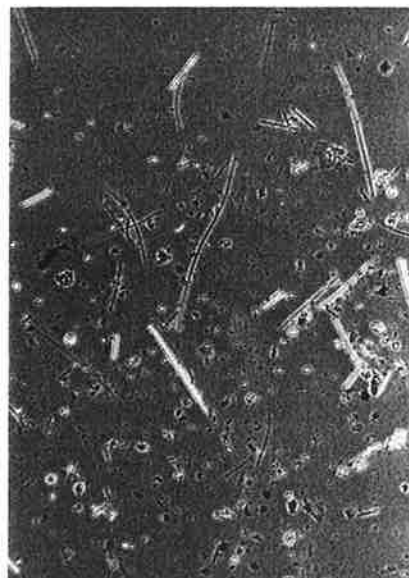
Foto 3. Geprepareerd filter met asbestvezels, glaswolvazels en stofdeeltjes
