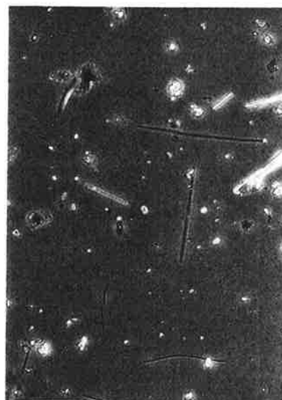
Foto 4. Geprepareerd filter met asbestvezels, glaswolvazels en stof (detail)
